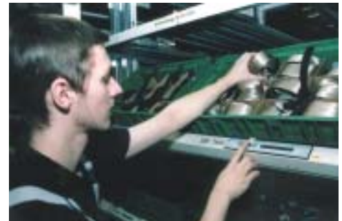
Abb. 1: Die Laserfachsteuerung kontrolliert die Bewegungen im Regal und bestätigt dem Mitarbeiter durch das Löschen der Lampe, dass er ins richtige Fach gegriffen hat.
