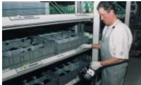
Abb.2: Nach der Entnahme aus dem angezeigten Fach, bestätigt der Mitarbeiter den Vorgang. Je nach Programmierung des Poka-Yoke-Systems kann die Entnahme auch automatisch quittiert werden.
