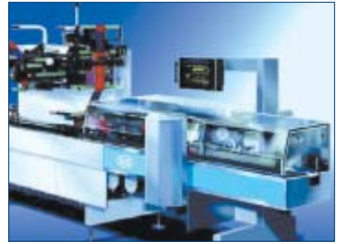
Abb.3: Die SIG-Verpackungsmaschine verfügt über ein verteiltes Steuerungssystem.
