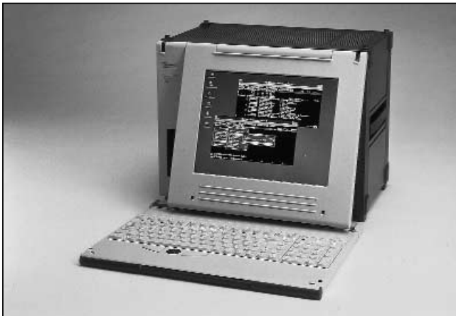
Abb. 3: Ein moderner Protokolltester wie der K1297-G20 ist leicht und lässt sich bequem zu jedem Netzwerkstandort mitnehmen
