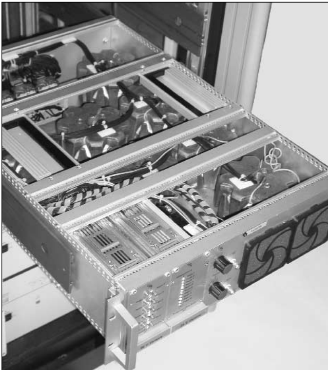
Abb. 2: Jeweils 10 Spulen mit der entsprechenden Peripheriebeschaltung wurden in einem 19"-Einschub als ‚Schublade‘ ausgeführt
