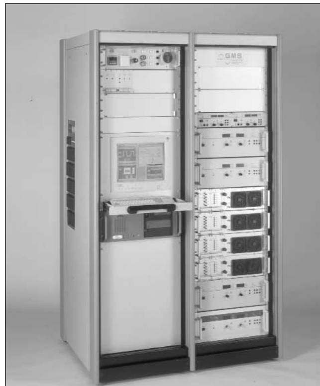
Abb. 1: Die gesamte Elektronik wurde in einem Doppel-19"-Schrank eingebaut
