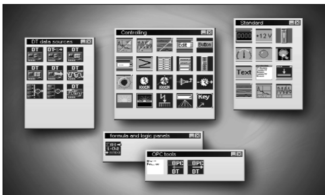
Abb. 3: Die ‚Flying Toolboxes‘ beinhalten alle elementaren Werkzeuge für eine Mess- und Prüfanwendung: z.B. Hardwareanbindung, Visualisierung, Auswertung und Speicherung
