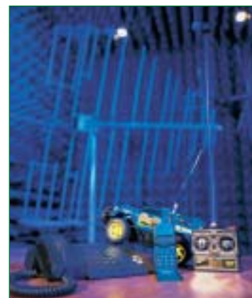
Abb. 3: Um zu gewährleisten, dass elektronische Geräte sich durch die Abstrahlung elektromagnetischer Felder nicht gegenseitig in ihrer Funktion stören, durchlaufen sie EMV-Tests, bei denen u.a. geprüft wird, welche möglichen Störungen ein Gerät aussendet und wie es auf Störeinwirkung durch ein anderes elektronisches Gerät reagiert.
