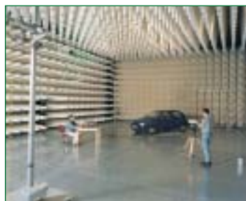
Abb. 2: In den Absorber-Hallen von Cetecom können Prüflinge bis zur Größe eines Pkw auf ihre elektromagnetische Verträglichkeit hin untersucht werden.
