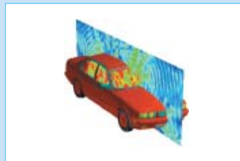
Abb. 4: Abstrahlung einer im Inneren eines PKW befindlichen Antenne
