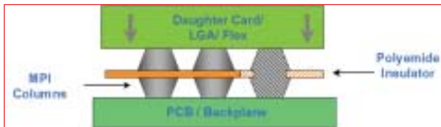
Abb. 2: Prinzipieller Aufbau von MPI-Verbindern
