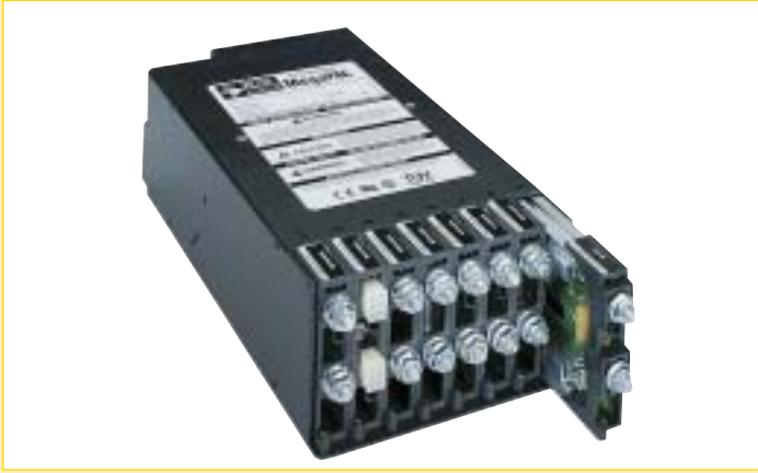
Abb. 2: Ein Beispiel für eine konfigurierbare Stromversorgung ist dieses PFC-Schaltnetzteil, das bis zu 2400 Watt liefert und maximal 16 isolierte Ausgänge bereitstellt.
