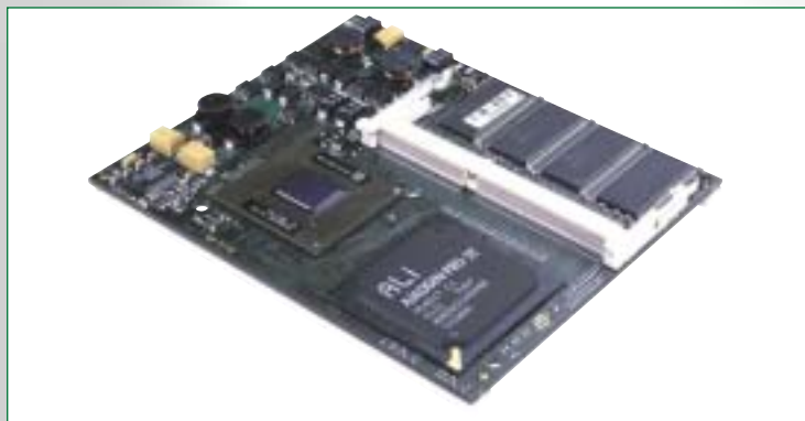
Abb. 2: Das TQ-Minimodul, TQM P3 ist mit dem Low-Power-Pentium-III-Mikroprozessor von Intel ausgestattet und misst nur 108 x 88 mm
