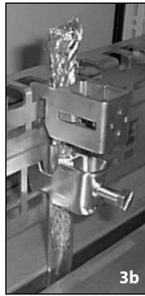
Abb. 3a, b: Kabelabfangschiene mit Potenzialausgleichsmöglichkeit; Zugentlastung und Schirmkontaktierung
