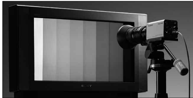
Abb. 1: Bei der objektiven Bildbewertung durch Referenzbildvergleich wird das Referenz- und das Testbild vom Bildschirm des Messobjekts mittels CCD-Kamera aufgenommen
