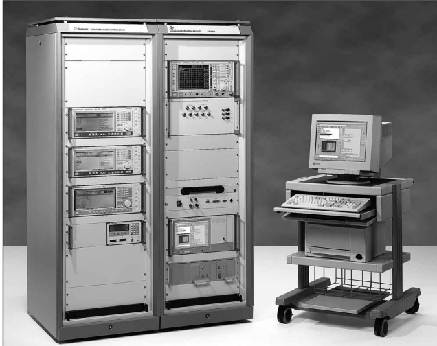
Abb.2: Im R&S TS8960 laufen alle 16 Testfälle zur Ermittlung der Hochfrequenzeigenschaften eines Bluetooth Produkts ab
