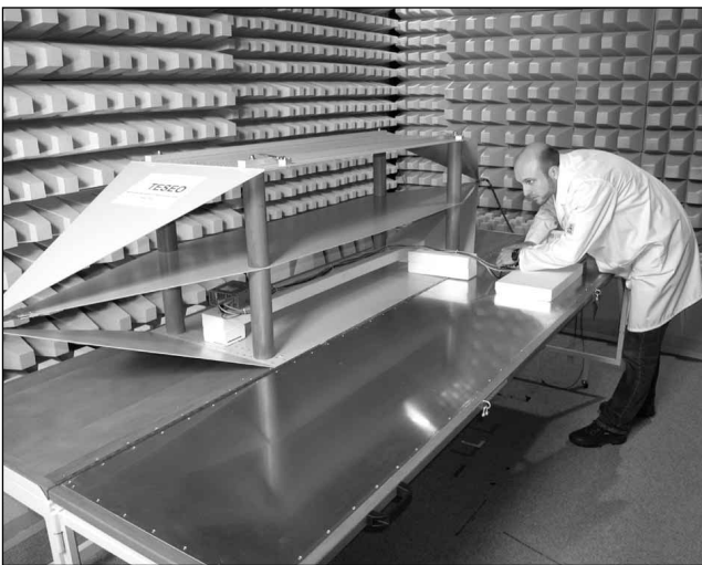
Abb.3: Störfestigkeitsunter- suchungen mittels TRI-Plate in der Absorberhalle
