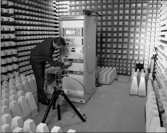
Abb.2: Gestrahlte Störfestig- keitsuntersuchung bis 18 GHz in der Absorberhalle
