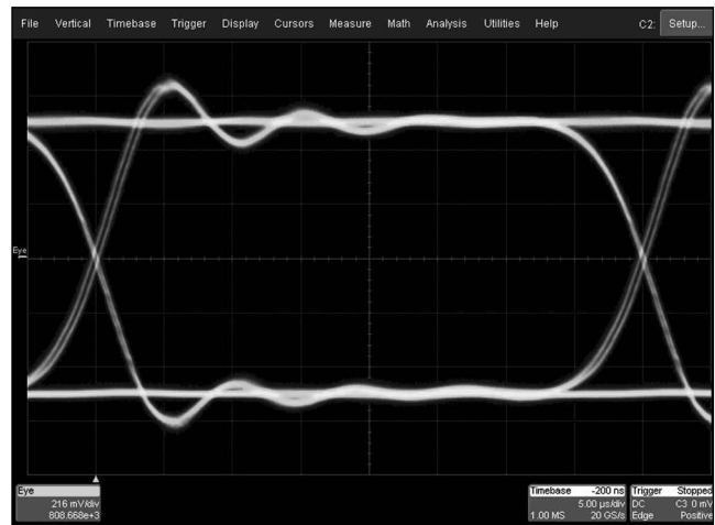
Abb. 1b: Dasselbe Signal wie in Abb. 1a mit einem einzigen Trigger. Der lange kontinuierliche Datenstrom wurde aber über viele Bits erfasst. Es gibt keinen Trigger-Jitter und zur Taktwiedergewinnung wurde ein mathematisches Verfahren genutzt. Das Augendiagramm ist viel klarer als in Abbildung 1a. Beachtenswert ist, dass die Flankenverschiebung durch die Intersymbol-Interferenz an der Separation der steigenden Flanke erkannt werden kann
