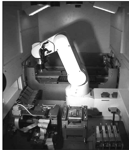
Abb. 1: Innenraum des Testhandlers
